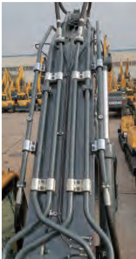
优化油管，减少压损，工作效率提升（破碎管路选配）
