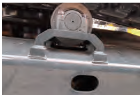
托链轮采用双边支撑形式，耐久性更好
