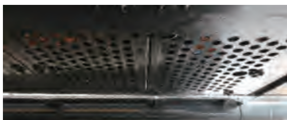
优化散热结构 主泵罩盖及维修孔板等增加透气孔提高散热性
