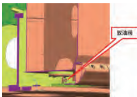
变更前（R485LVS）： 放油阀安装在油箱底部
