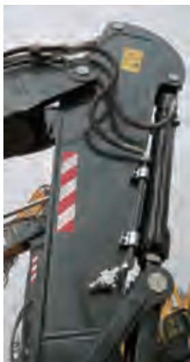
选配破碎管路，与现代破碎器配合使用稳定高效
